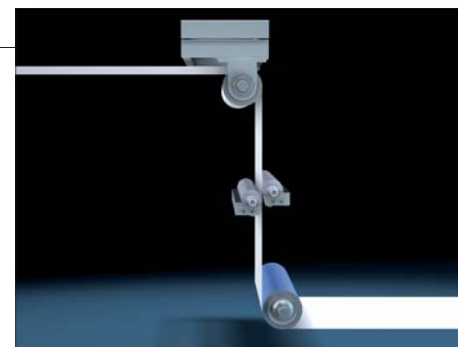
L'unità di trattamento Ironman include rulli con incarto a L raffreddati, guida di direzione e applicatore di silicone raffreddato con rulli opposti.
