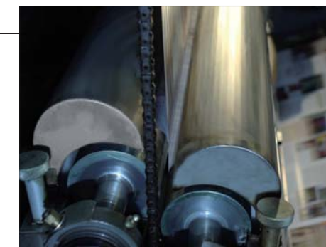
Uno strato di silicone freddo viene applicato al nastro dai rulli applicatori raffreddati.
