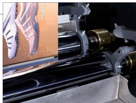
Innovativo applicatore di silicone con rulli raffreddati per un peso della pellicola uniforme e basso.
