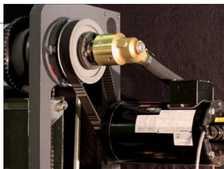
Azionamento dei robusti rulli di acciaio che consente l'utilizzo dei raccordi rotativi e dei cuscinetti convenzionali.
